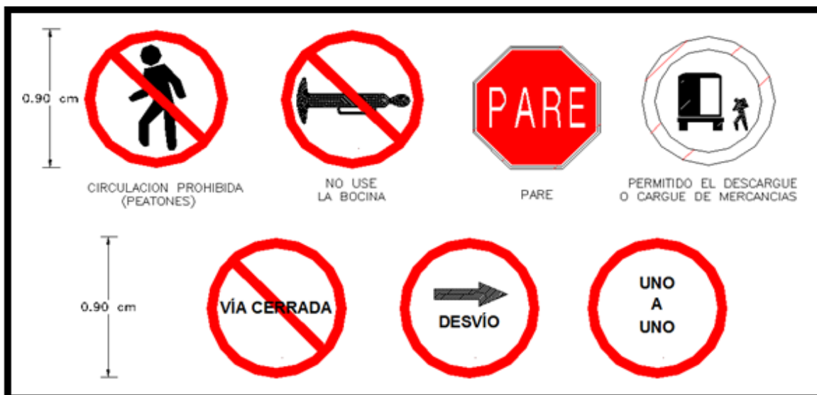
Figura 2-49 Tipo de señalización reglamentaria
