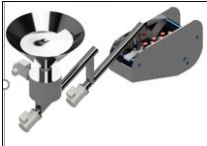
Figura 2.117 Equipo tipo para el proceso de Inertización. Tratamiento Insitu-Uso de KUBOX.
