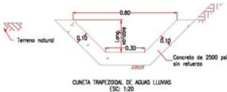
Figura 2.42 Cunetas perimetrales.
