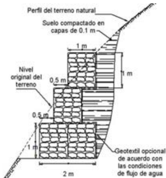
Figura 2.51 Muro de gaviones.
