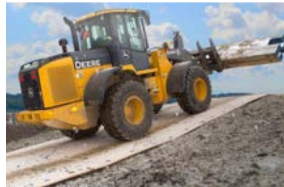
Fotografía 2.11 Superficie modular portátil en polietileno de alta resistencia.
