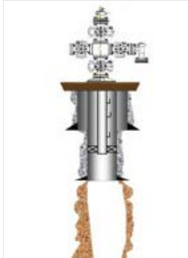
Figura 2.66 Esquema tipo de completamiento en hueco desnudo
