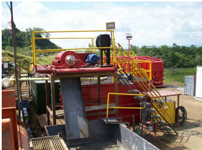
Fotografía 2.34 Equipo del Sistema de Control de Sólidos
