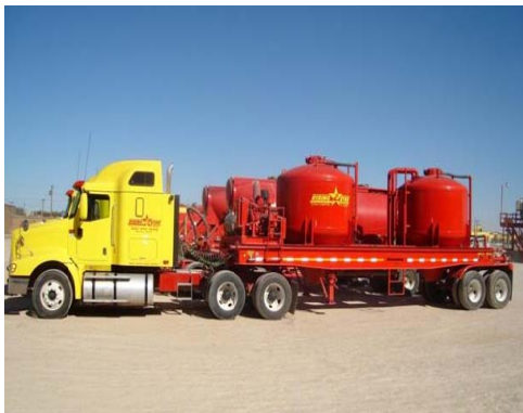
Fotografía 2.67 Equipo de cementación.
