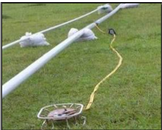
Fotografía 2- 70: Prueba radiográfica, toma de placas.
