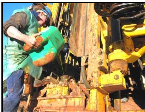
Fotografía 2- 52: Adición de lodo base agua durante el proceso de perforación de un pozo exploratorio.
