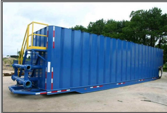
Fotografía 2- 45: Frack tank típico.
