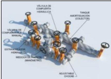
Figura 2-45: Esquema tipo del sistema para control del pozo y prevención de reventones
