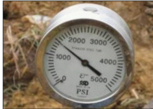
Fotografía 2-76: Registro típico de una prueba hidrostática.
