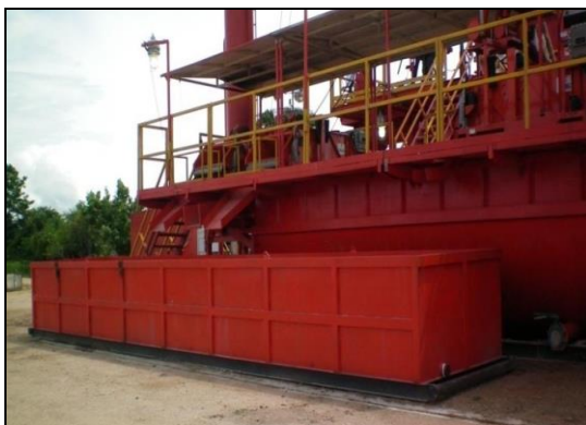
Fotografía 2-50: Unidades del sistema tipo de control de sólidos (base agua).
