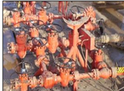
Figura 2-45: Esquema tipo del sistema para control del pozo y prevención de reventones
