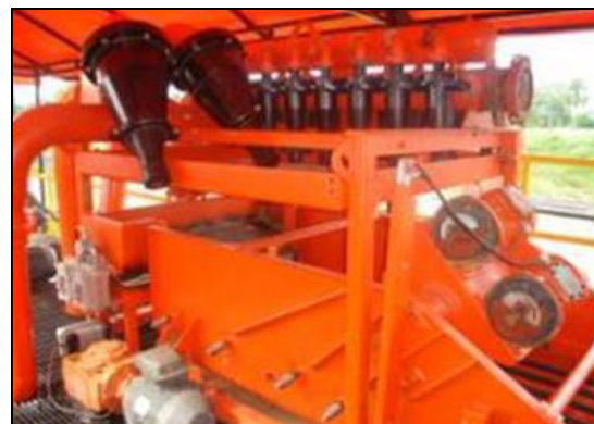
Fotografía 2-50: Unidades del sistema tipo de control de sólidos (base agua).
