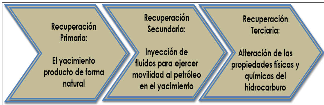
Figura 2-61: Mecanismos de recuperación de hidrocarburos durante la vida productiva de un yacimiento.
