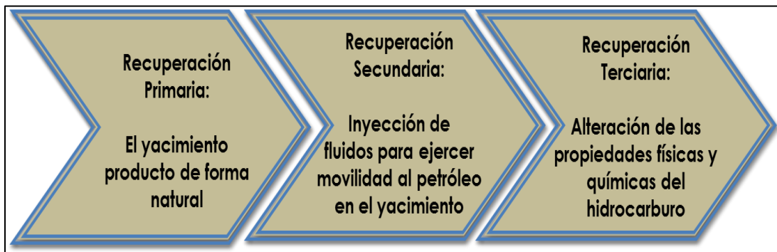
Figura 2-64: Mecanismos de recuperación de hidrocarburos durante la vida productiva de un yacimiento.
