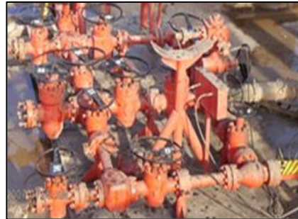
Figura 2-48: Esquema tipo del sistema para control del pozo y prevención de reventones
