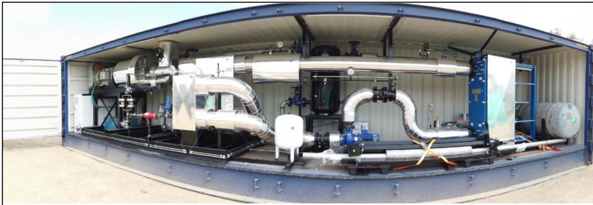
Figura 2-104: Unidad de optimización del potencial calórico proveniente del agua de producción
