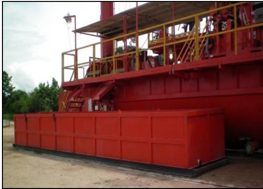
Fotografía 2-69: Unidades del sistema tipo de control de sólidos (base agua).
