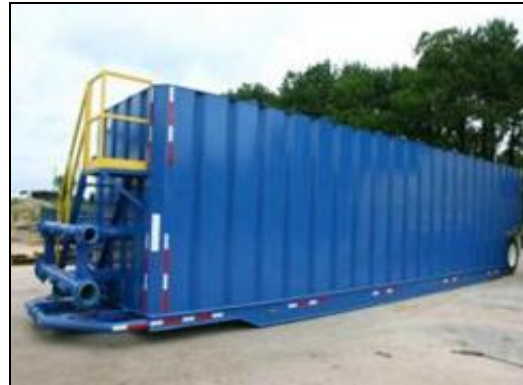
Fotografía 2-51: Tanques australianos y tanques tipo frac tank.
