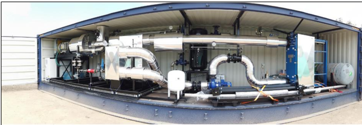
Figura 2-130: Unidad de optimización del potencial calórico proveniente del agua de producción
