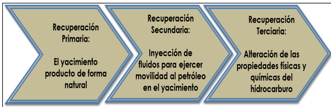
Figura 2-87: Mecanismos de recuperación de hidrocarburos durante la vida productiva de un yacimiento.
