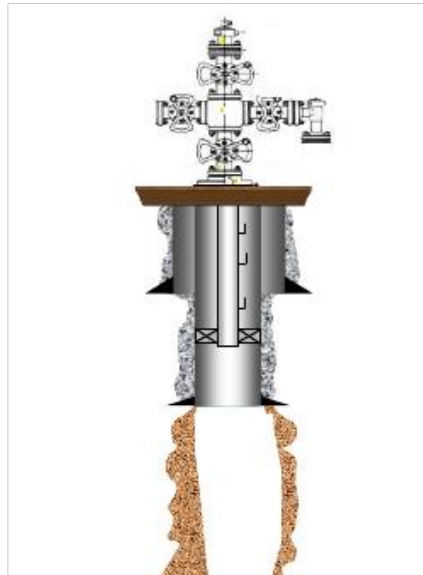
Figura 2-73: Esquema típico completamiento en huevo desnudo
