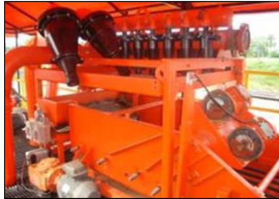
Fotografía 2-69: Unidades del sistema tipo de control de sólidos (base agua).
