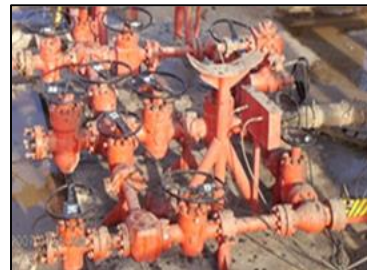
Figura 2-65: Esquema tipo del sistema para control del pozo y prevención de reventones
