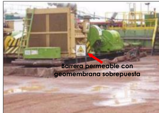
Fotografía 2-32: Equipos ubicados sobre geomembranas con diques de contención.
