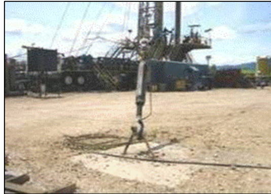
Fotografía 2-43: Anclajes de concreto.
