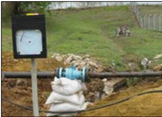
Fotografía 2-96: Registro típico de una prueba hidrostática.
