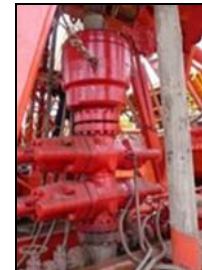
Figura 2-65: Esquema tipo del sistema para control del pozo y prevención de reventones
