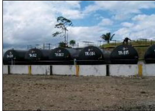
Fotografía 2-75: Tanques tipo para el manejo de fluidos de la perforación.
